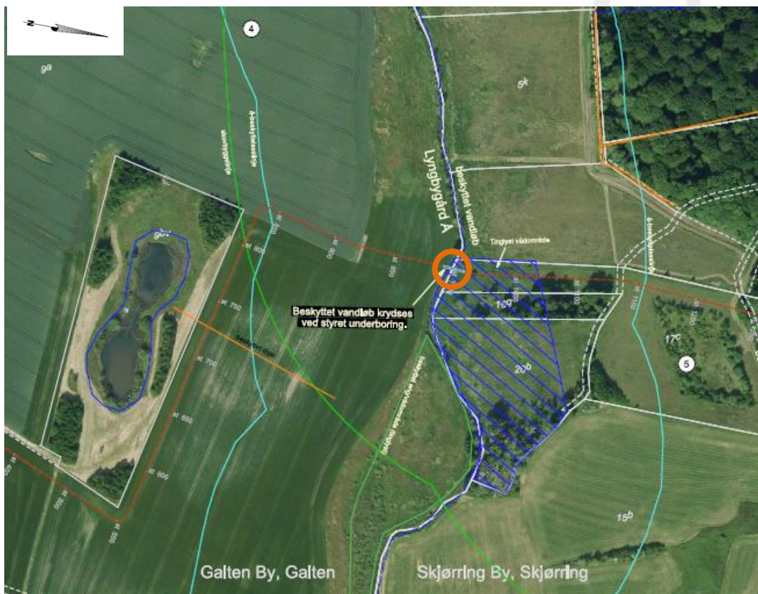
Figur 1: Krydsningspunkt (orange ring) i Lyngbygård Å v. matr. nr. 9a Galten By, Galten og matr. nr. 17c Skjerring By, Skjerring – vådområdet krydses også via underboring (fra LIFAs ansøgningsmateriale).
